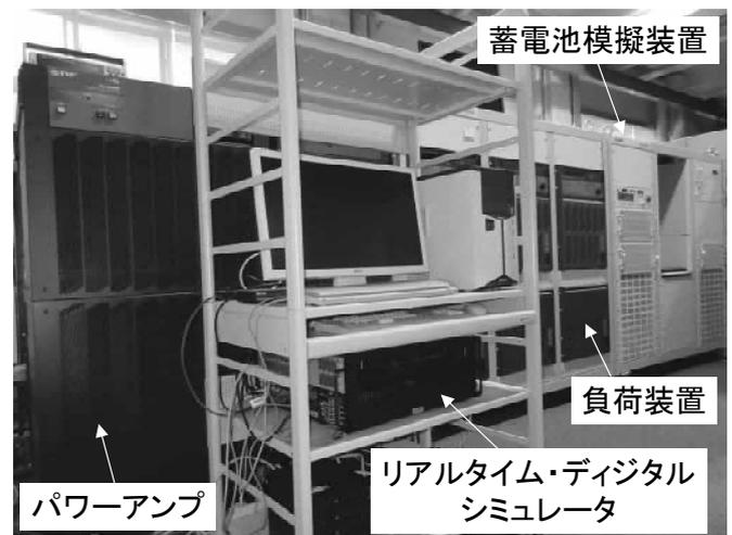
図 1 電力シミュレータ外観
